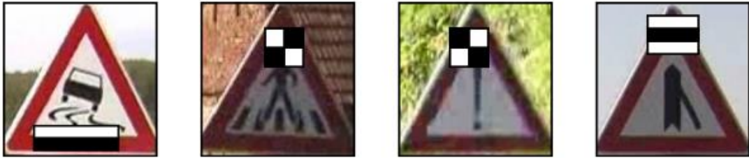
Τα πρώτα τέσσερα χαρακτηριστικά στο πρώτο επίπεδο του cascade ανιχνευτή ΠΗΓΗ: Brkić et al. (2009) [74]
