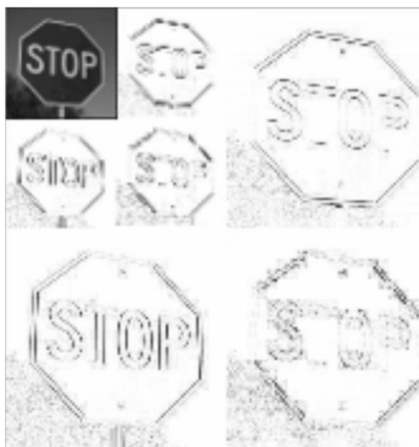
Αποσύνθεση δεύτερου επιπέδου εικόνας Stop Stop με χρήση Haar Wavelet ΠΗΓΗ: Escalera et al. (2011) [11]
