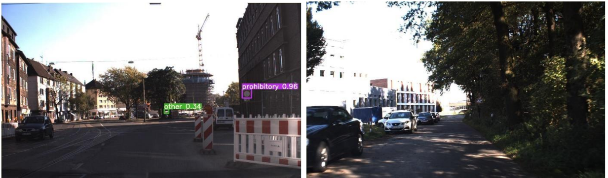
Παράδειγμα αποτυχημένης ανίχνευσης και αναγνώρισης φόντου ως πινακίδα (αριστερά) και παράδειγμα πλήρους αποτυχίας ανίχνευσης σήματος αναγόρευσης κινδύνου λόγω αποκρύψεων (δεξιά) από το σύνολο των δεδομένων αξιολόγησης του YOLOv3
