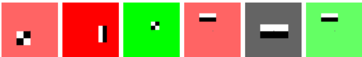
Τα top 6 χαρακτηριστικά του ανιχνευτή. Τα εικονοστοιχεία κάτω από τις λευκές περιοχές σταθμίζονται κατά +1, η μαύρη περιοχή κατά -1. Το φόντο υποδεικνύει το κανάλι χρώματος στο οποίο υπολογίζονται μεμονωμένα τα χαρακτηριστικά, εδώ αντιστοιχεί σε r, R, G, r, S/3, g . ΠΗΓΗ: Bahlmann et al. (2005) [73]
