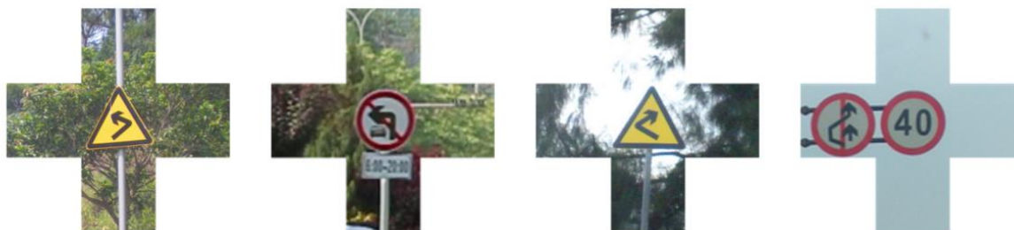
Πινακίδες κυκλοφορίας με δευτερεύουσες περιοχές ενδιαφέροντος (SROI) σε σχήμα σταυρού. ΠΗΓΗ: Shao et al. (2019) [122]
