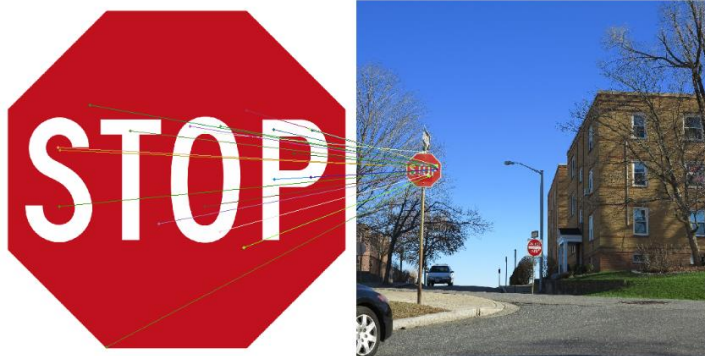
Ταύτιση χαρακτηριστικών πινακίδας STOP με φυσική εικόνα ΠΗΓΗ : Zhao et al. (2013) [82]
