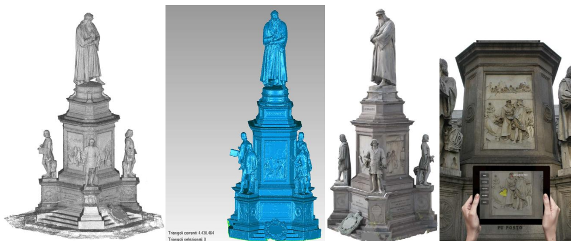
Εικόνα 93. Στάδια επεξεργασίας (από αριστερά προς τα δεξιά): Νέφος σημείων του αγάλματος χωρικά ενταγμένο (Registered) στο λογισμικό Cyclone Αντίστροφη μοντελοποίηση του μνημείου στο λογισμικό Geomagic Studio 3D μοντέλο με εφαρμοσμένη υφή Χρήση της εφαρμογής AR για φορητή συσκευή στο άγαλμα του Λεονάρντο ντα Βίντσι.
