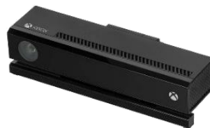
Εικόνα 20α. Παραδείγματα εικονοσημάτων, fiducial markers (αριστερά). Εικόνα 20β. Κάμερα βάρθους Microsoft Kinect 2 (δεξιά)
