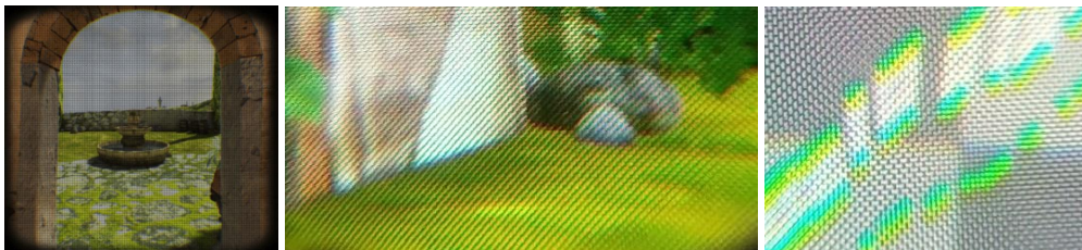
Εικόνα 7α και 7β. Screen Door Effect, Εικόνα 7γ. Screen Door Effect στο σύστημα Oculus Rift DK2.
