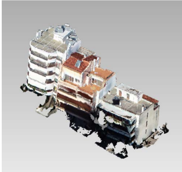
Εικόνα 4.31: Δημιουργία πρότυπων μοντέλων στο Geomagic - Πολυκατοικία.
