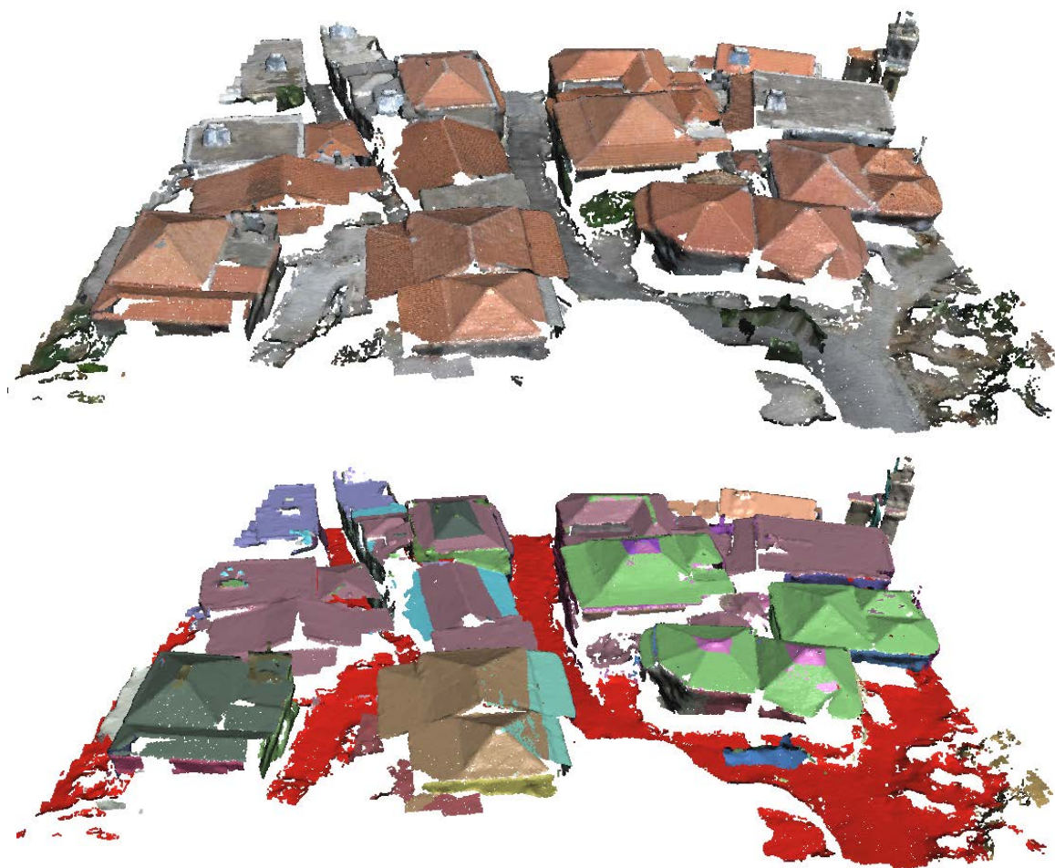
Εικόνα 4.17: Κατάμηση νέφους οικισμού στο mapple (1).
