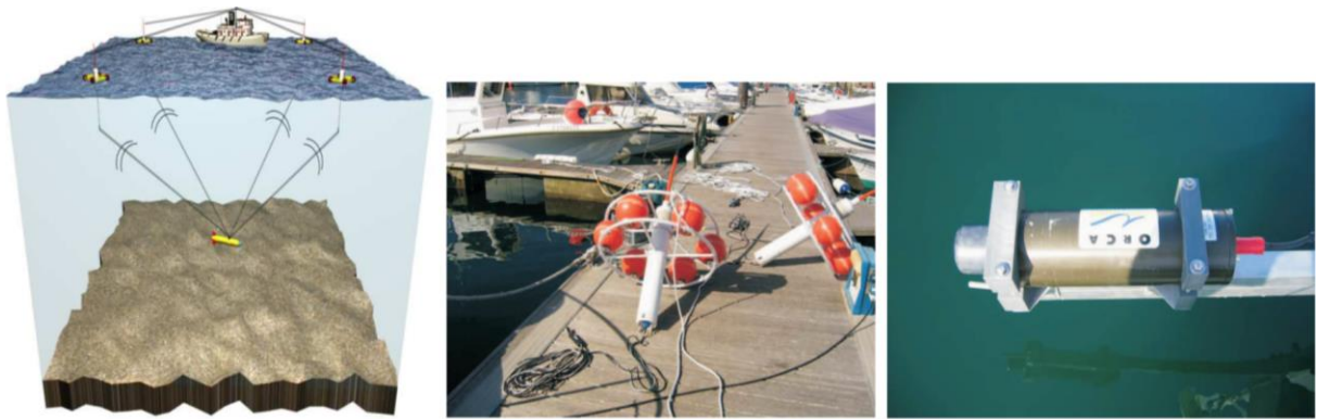
Εικόνα 2.9: Σύστημα GPS Intelligent Buoys (GIB), (Alcocer et al., 2006)
