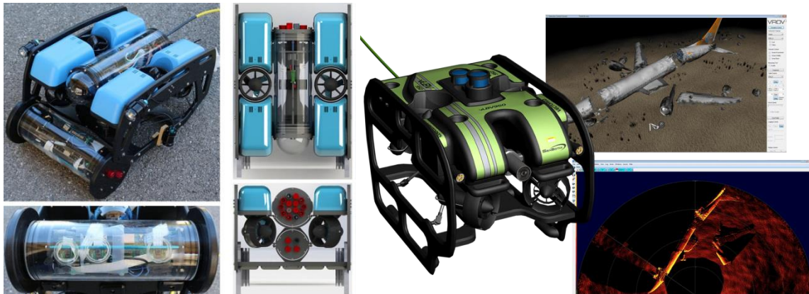
Εικόνα 1.8: Τα mini commercial ROVs BlueRov2 (αριστερά, www.bluerobotics.com ) και Seabotix (δεξιά, www.teledynemarine.com/ )
