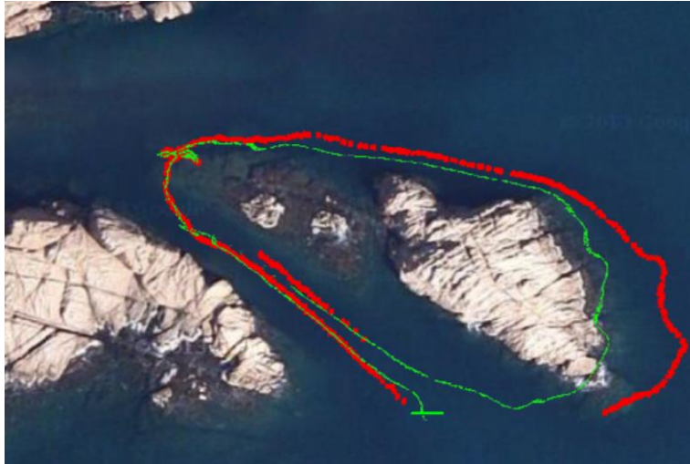
Εικόνα 4.8: Η πορεία του Sparus II AUV εντός του υποβρύχιου φαραγγιού. Με κόκκινη γραμμή η πορεία του οχήματος όπως προσδιορίστηκε από τις θέσεις των καμερών κατά την επίλυση SfM και με πράσινη γραμμή η πορεία του οχήματος βάσει της μεθόδου προσδιορισμού θέσης dead reckoning (Hernández et al., 2016)
