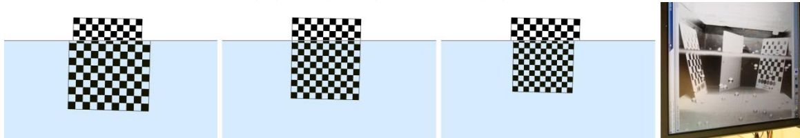
Εικόνα 3.14: Διαδικασία ευθυγράμμισης θόλου, με μερική βύθιση του πεδίου βαθμονόμησης και οπτικό έλεγχο, για την απαλοιφή της διάθλασης (She et al., 2019).
