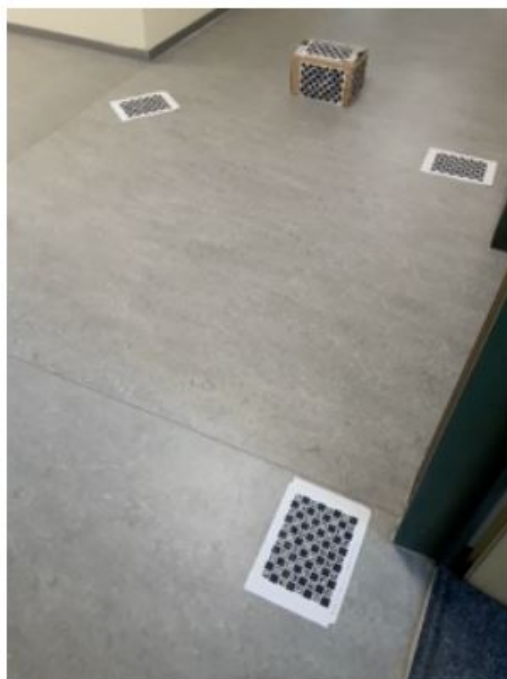
Εικόνα 11. Τοποθέτηση στόχων για εκτέλεση αλγορίθμου σε σενάριο εσωτερικού χώρου
