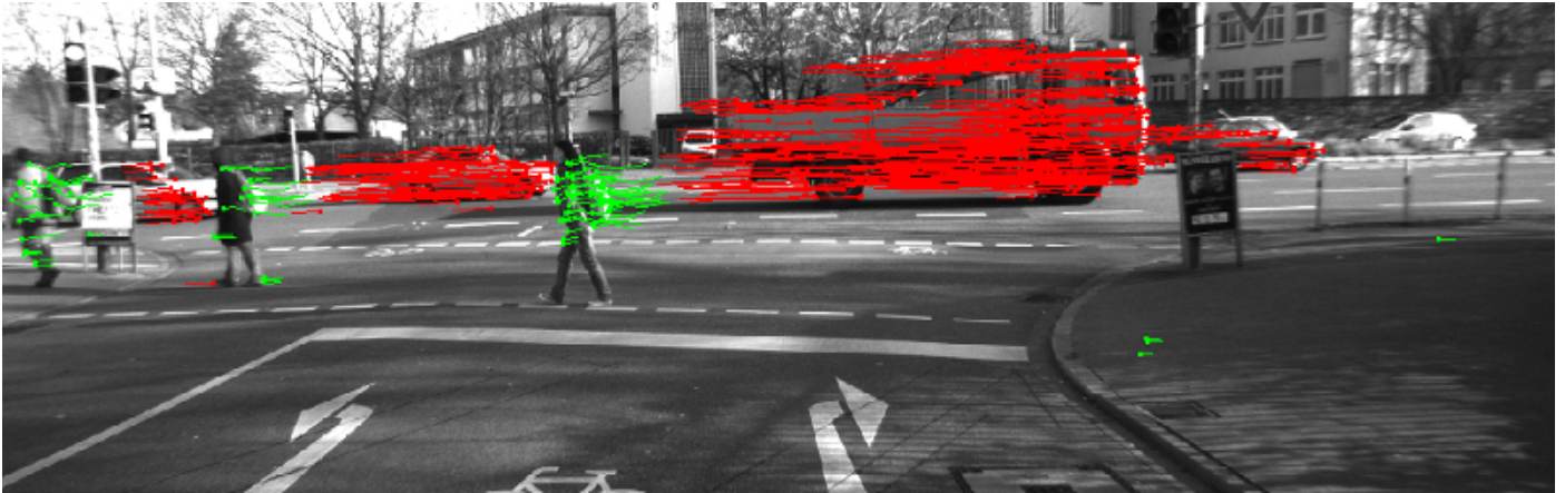
Εικόνα 7.Οπτική οδομετρία με χρήση Libviso2
