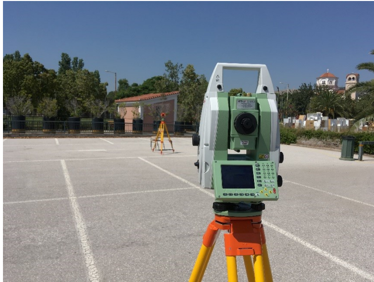
Εικόνα 34 - Μέτρηση απόστασης μεταξύ T1 - T2 με χρήση γεωδαιτικού σταθμού. Οι παρατηρήσεις του γεωδαιτικού σταθμού από το T1 προς το T2 και από το T2 προς το T1, σε δύο θέσεις τηλεσκοπίου αντίστοιχα, απεικονίζονται στον παρακάτω Πίνακα:
