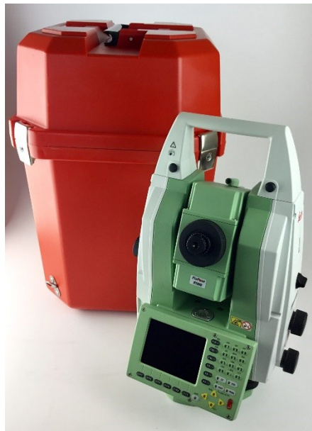
Εικόνα 26 - Ο ρομποτικός γεωδαιτικός σταθμός Leica TS30 (πηγή: https://www.precision-geosystems.com )
