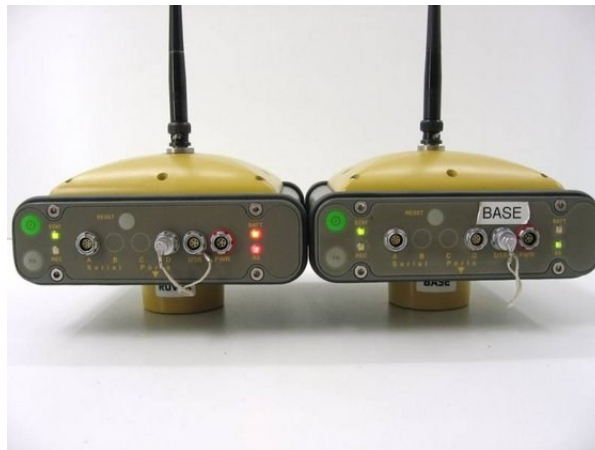
Εικόνα 25 - Ο γεωδαιτικός δέκτης GPS Topcon HiPer PRO (πηγή: http://surveyingstation.com )
