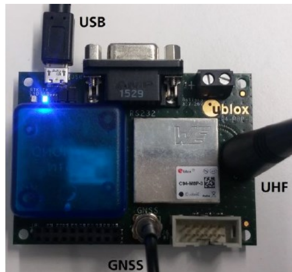
Εικόνα 18 - Ο δέκτης u-blox που χρησιμοποιήθηκε. Διακρίνεται το κεντρικό chipset του δέκτη ενσωματωμένο στη πλακέτα διεπαφής και οι διασυνδέσεις USB, RS232, UHF, κεραίας GNSS, και οι ενδείξεις LED για την κατάσταση λειτουργίας και λειτουργία RTK. (Πηγή: C94-M8P Application Board Setup Guide)
