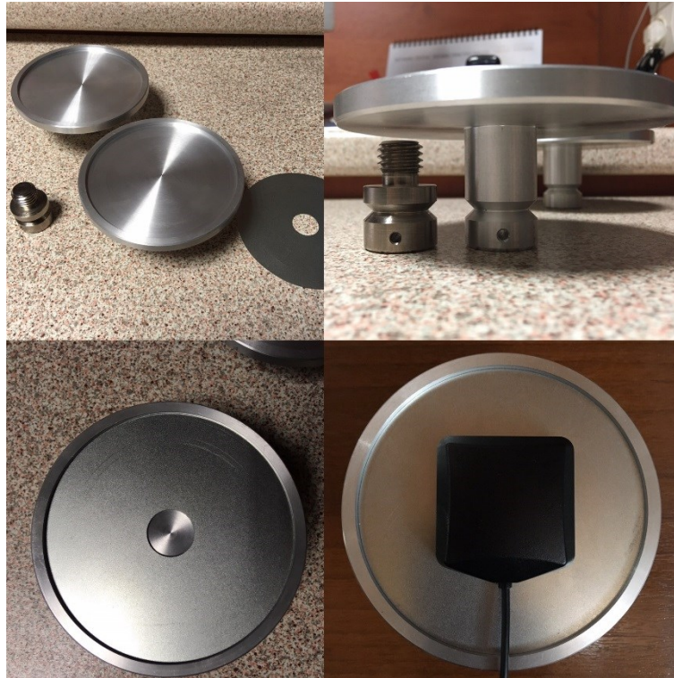
Εικόνα 29 - Οι κατασκευασμένες βάσεις αλουμινίου.
