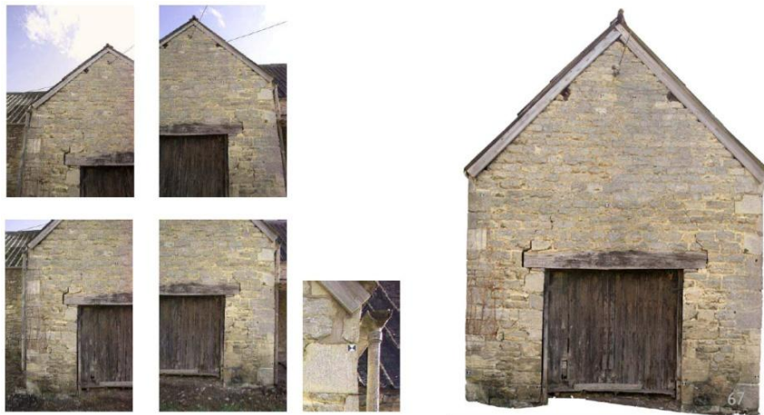
Εικόνα 2.5: Παρουσίαση Φωτογραμμετρικής μεθόδου στην δημιουργία ορθοφωτογραφίας για την απόδοση όψης κτιρίου (Blake). Οι φωτογραφίες της όψης οφείλουν να παρουσιάζουν συγκεκριμένο ποσοστό αλληλοεπικάλυψης, ενώ μέσω EDM λαμβάνονται συντεταγμένες συγκεκριμένων σημείων-στόχων επί της όψης για την αναγωγή της.
