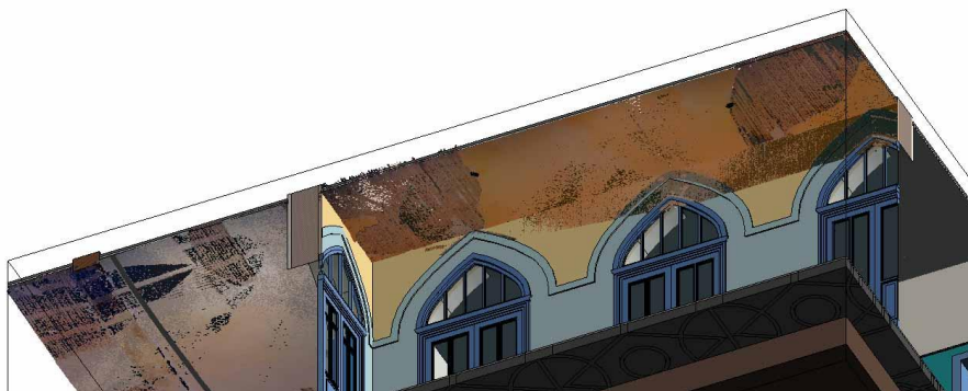
Εικόνα 5.23: Νέφος σημείων επί του δημιουργημένου μοντέλου. Εμφάνιση μετρίσιμων αποκλίσεων της παρούσας κατάστασης (νέφος) από την κανονική μορφή του ψηφιακού μοντέλου.
