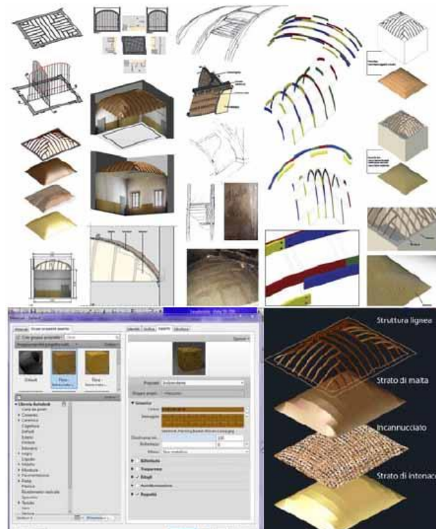
Εικόνα 3.16: HBIM (Autodesk Revit) ξύλινου θόλου Soldi Palace in Cremona, Ιταλία (Oreni 2013). Η διαδικασία μοντελοποίησης περιλαμβάνει πληροφορίες ως προς τα υλικά, τη στρωματογραφία και τη γεωμετρία των αρχιτεκτονικών στοιχείων σε κοινή βάση δεδομένων.
