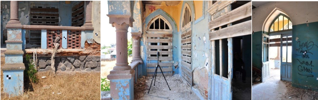
Εικόνα 5.3: Τοποθέτηση αυτοκόλλητων στόχων στο εξωτερικό και εσωτερικό του τμήματος σάρωσης.
